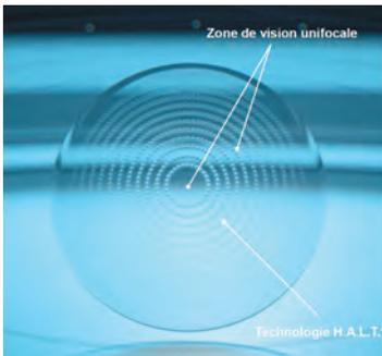
**Figure 4 - Verre Stellest d'Essilor de technologie HALT : correction myopique (zone unifocale) + contrôle de la progression myopique (HALT = Highly Aspherical Lenslet Target, constellation de microlentilles asphériques contiguës).**
